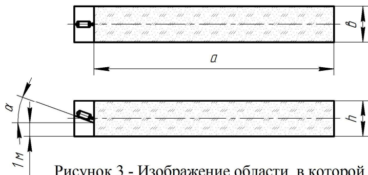
Рисунок 3 - Изображение области, в которой достигается тушение пожара класса А
